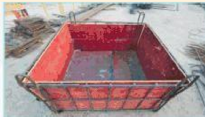
使用圆钢材料做吊环
